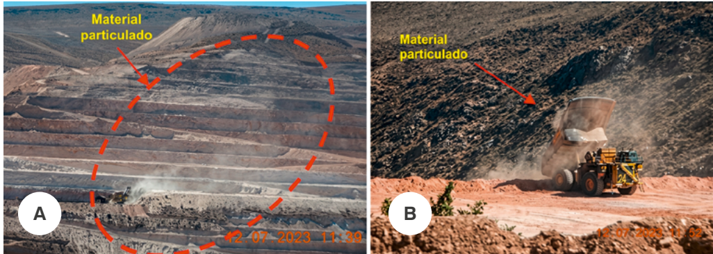
Figura 97. Vista de la dispersión de material particulado durante las operaciones en el Tajo Quellaveco (a) y Vista cercana de la dispersión de material particulado generado por la descarga de material desde el volquete en el depósito de material estéril Altaranito (b)
